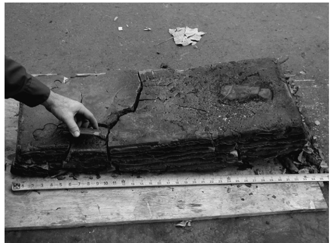
Fig. 5. Slag ingot in pouring mold.
